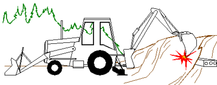
Figura 1 - Contatto con linee elettriche interrate
